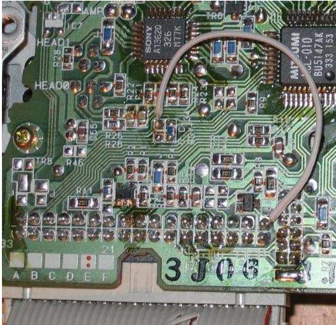
Die Position des 0 Ohm SMD Widerstandes ist zu tauschen und man muss Pin 2 des 3-poligen Anschlusses mit dem nun freien linken oberen Löt pads verbinden.
