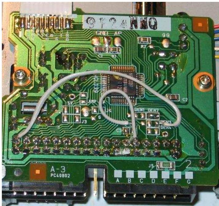
Das Jumperfeld mit der Beschriftung "DEN2" muss geschlossen werden und schon hat man das Diskchange Signal
